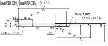
※引き出した状態でボールロックが働き、簡易ロックをします。
