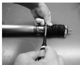
後部の金具のネジ緩め
