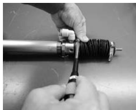
後部の金具のネジ締め
