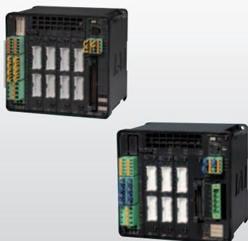
ロボシリンダポジションコントローラ 8 軸タイプ
